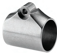
Magnum-Ringriemenbügel, zylindrisch. Kopfbreite: 8 mm; Bohrung: \varnothing 3,6 mm; Ringbreite: 30,0 mm
